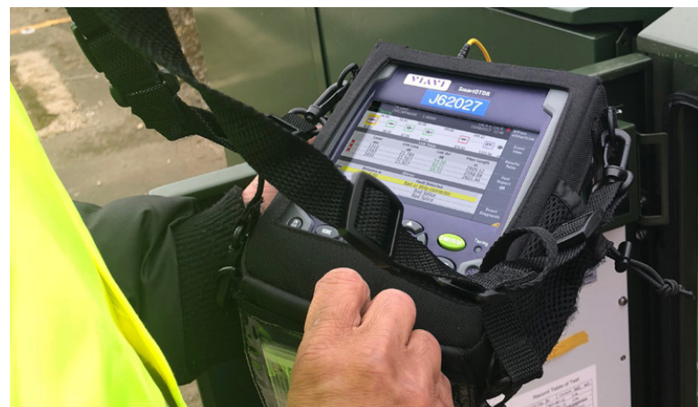
负责工程师可以坐在办公室中远程查看新手技术人员的 OTDR 用户界面
